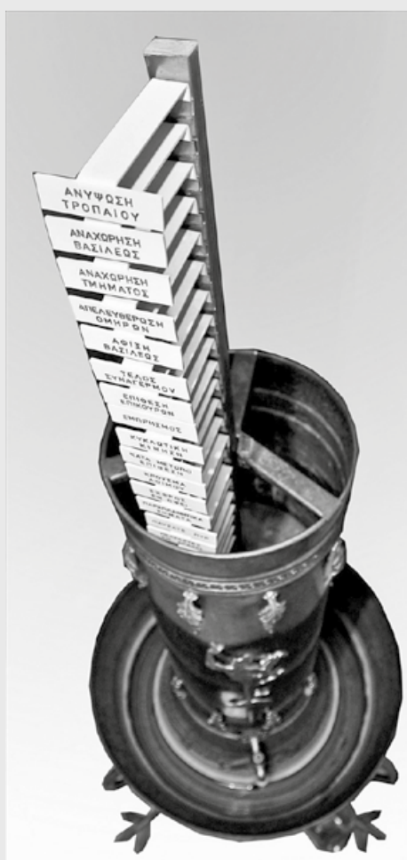
Ο υδραυλικός τηλεγράφος που επινόησε ο Αινείας ο Τακτικός (μέσα 4ου αι. π.Χ.) για ταχεία αποστολή προσυμφωνημένων μηνυμάτων σε μεγάλες αποστάσεις, κυρίως σε καιρούς πολέμου. Ομοίωμα στο Μουσείο Τηλεπικοινωνιών Ομίλου ΟΤΕ.
