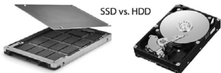
Η αντικατάσταση του μηχανικού σκληρού δίσκου με ένα SSD βελτιώνει αισθητά την ταχύτητα του υπολογιστή
